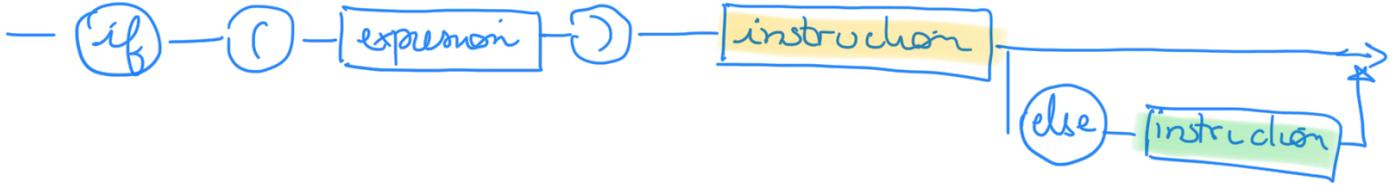
Objectif  $\Rightarrow$  Rendre l'exécution d'une action dépendante d'une condition.
