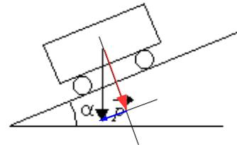
Il faut dessiner les deux composantes puis placer l'angle  $\alpha$  et enfin utiliser les relations trigonométriques :
