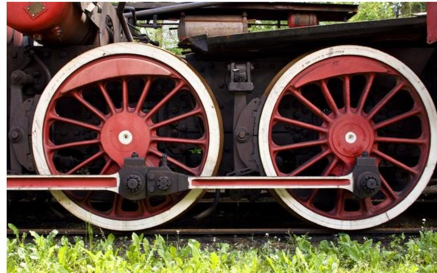
Système d'entraînement de roue de locomotive
