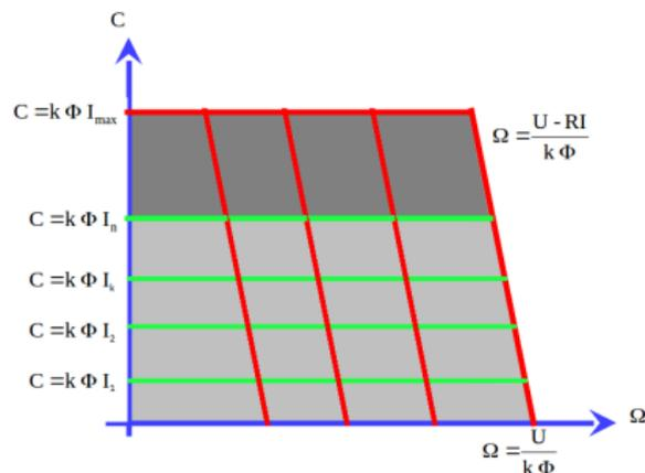
À flux constant ( $\Phi \approx cte \Rightarrow i_f \approx cte$ ), la vitesse varie proportionnellement à la tension d'armature  $U$  ( $U_1 < U_2 < U_k \dots < U_{max}$ ).
