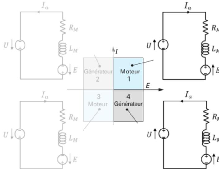
Avance de la voiture à vitesse  $v$  constante : en côte (mode moteur), en descente (mode générateur). Une alimentation à deux quadrants suffit.
