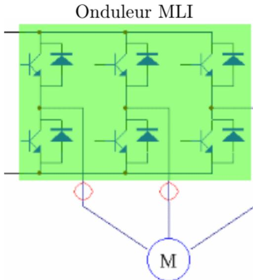
Les commutations de l'onduleur permettent le suivi d'une consigne imposant la fréquence et l'amplitude des signaux de sortie.
