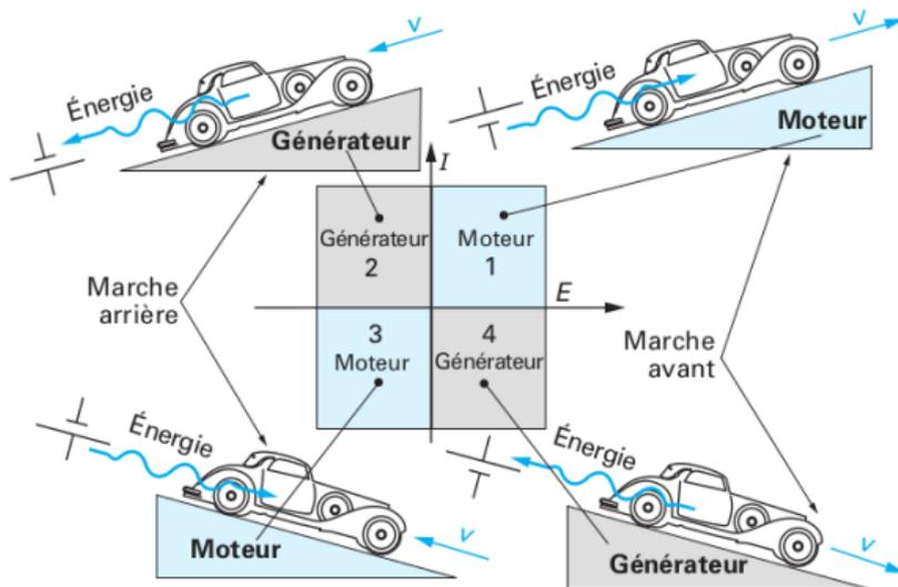
Les deux autres quadrants : la voiture recule en sens inverse dans une côte (mode générateur), la voiture monte en sens inverse une descente (mode moteur).
