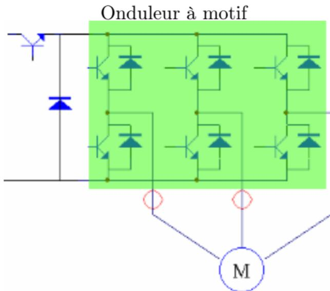
L'onduleur impose un motif et règle la fréquence des signaux de sortie.
