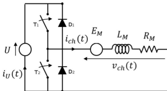
Si l'on détecte le passage du courant par zéro, la commande bascule d'un interrupteur à l'autre
