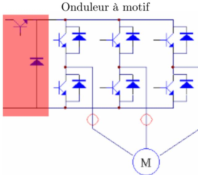
Le hacheur contrôle le niveau de tension
