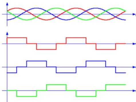
La connaissance de 3 positions du rotor de la machine suffit à l'élaboration des signaux, alors qu'il faut précisément la connaître dans le cas d'une alimentation sinusoïdale.
