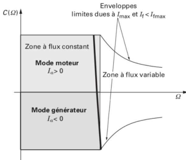
Le couple s'inverse, le moteur passe du mode moteur  $C > 0$  au mode générateur  $C < 0$  (la vitesse est toujours dans la même direction).
