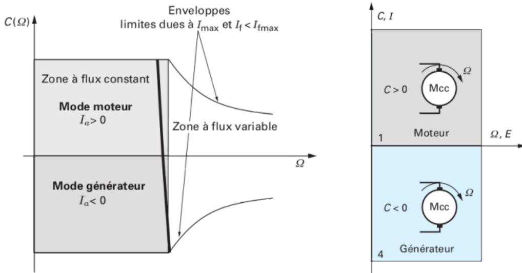
Le couple s'inverse, le moteur passe du mode moteur  $C > 0$  au mode générateur  $C < 0$  (la vitesse est toujours dans la même direction).
