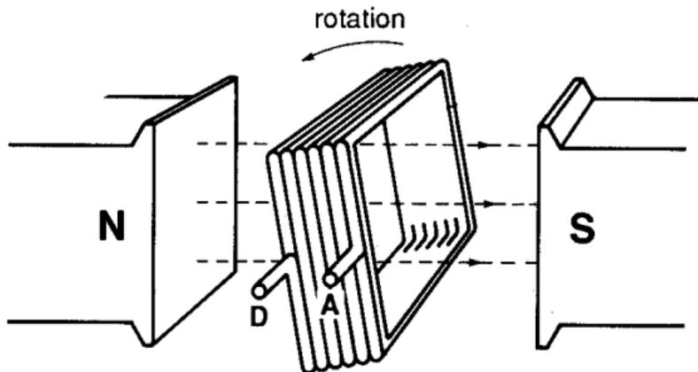
Bobinage en rotation (rotor) : induit, armature
