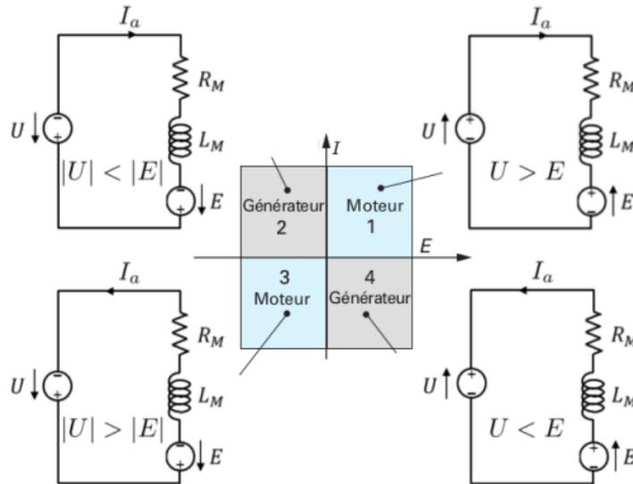
Nécessité d'adapter l'alimentation aux fonctionnement (quadrants) du système d'entraînement  $\Rightarrow$  Utilisation des convertisseurs.
