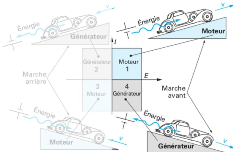
Avance de la voiture à vitesse  $v$  constante : en côte (mode moteur), en descente (mode générateur). Une alimentation à deux quadrants suffit.
