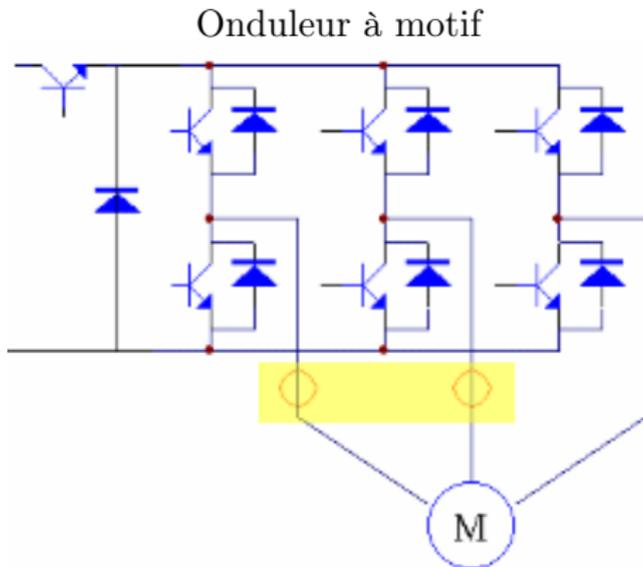
La mesure des courants agit sur le hacheur et l'onduleur pour limiter la valeur des courants.
