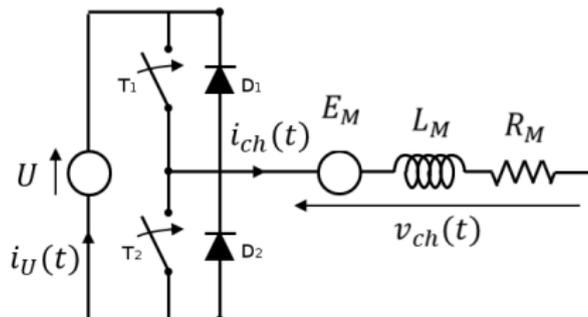
L'interrupteur  $T_1$  est fermé de 0 à  $\alpha T$  et l'interrupteur  $T_2$  de  $\alpha T$  à  $T$ . Le passage du mode de fonctionnement moteur à frein se fait de manière automatique.
