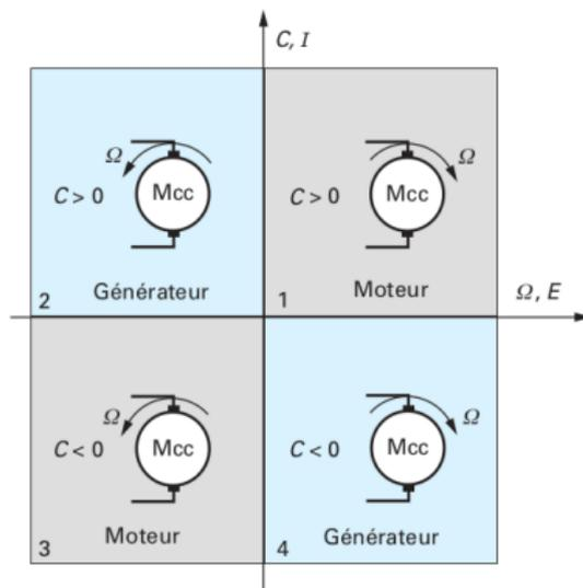
Changement de la direction de rotation  $\Omega < 0 \Rightarrow$  Inversion de la polarité de la tension d'armature  $U \equiv E$ .
