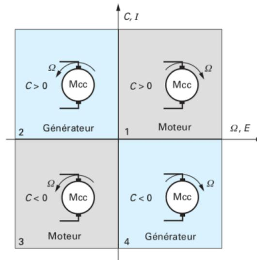
La charge (résistante ou entraînée) impose le passage vertical d'un quadrant à un autre sans changement du signe de la vitesse. Les transitions horizontales entre quadrants seront obtenues par une inversion de la tension de l'alimentation  $U$  (ou du courant d'excitation  $I_f$ ).
