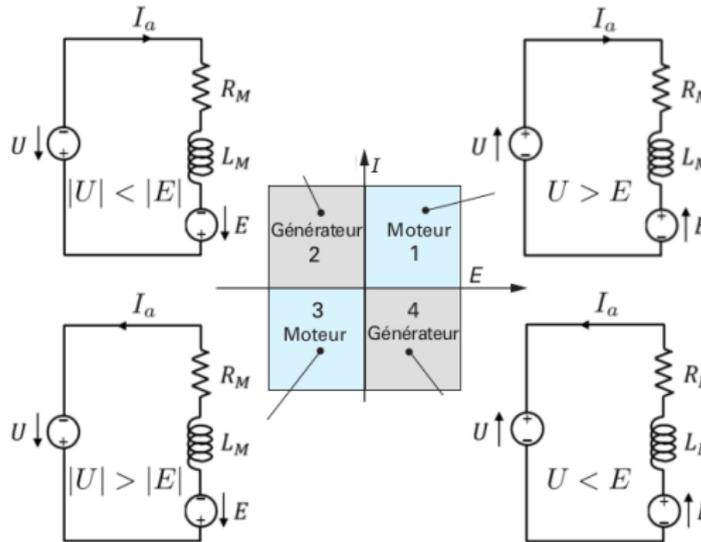
Les deux autres quadrants : la voiture recule en sens inverse dans une côte (mode générateur), la voiture monte en sens inverse une descente (mode moteur).
