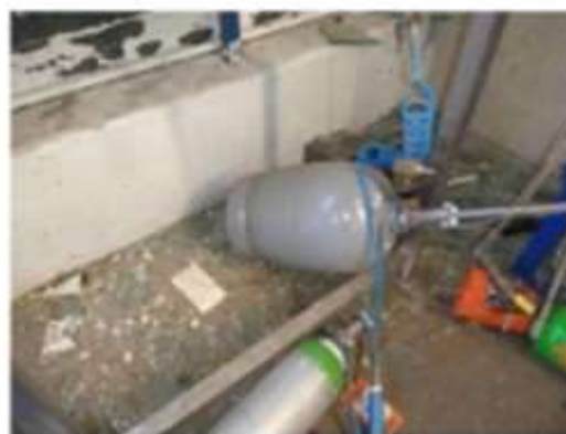
Figure 2 - S14 déformée par excès de pression
