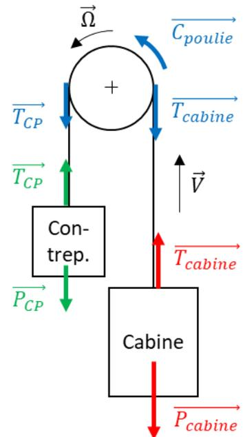
$$C_{poulie} = \left( J + M_{cabine} * \left( \frac{D}{2} \right)^2 + M_{CP} * \left( \frac{D}{2} \right)^2 \right) * \frac{d\Omega}{dt} + (P_{cabine} - P_{CP}) * \frac{D}{2}$$
