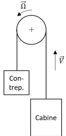
Modéliser le système du point de vue de la poulie et le mettre en équation à l'aide du PFD. Déterminer s'il faut prendre en compte la masse du câble.
