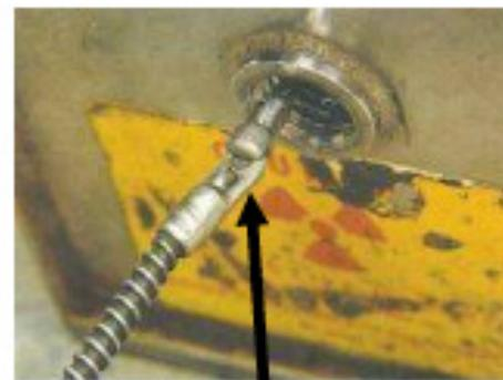
Figure 3. - Source exposée connectée au câble
