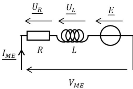
Figure 2 : circuit équivalent pour une phase
