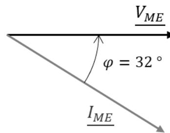
Figure 3 : diagramme de Fresnel incomplet
