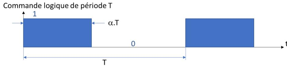
Figure 5 : graphe représentant la commande de l'interrupteur K1
