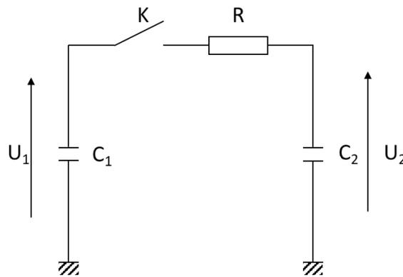
Figure 3.1 : circuit électrique
