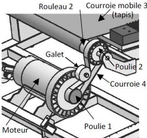
Le rayon de la poulie motrice 1 est  $R_{p1} = 27 \text{ mm}$
